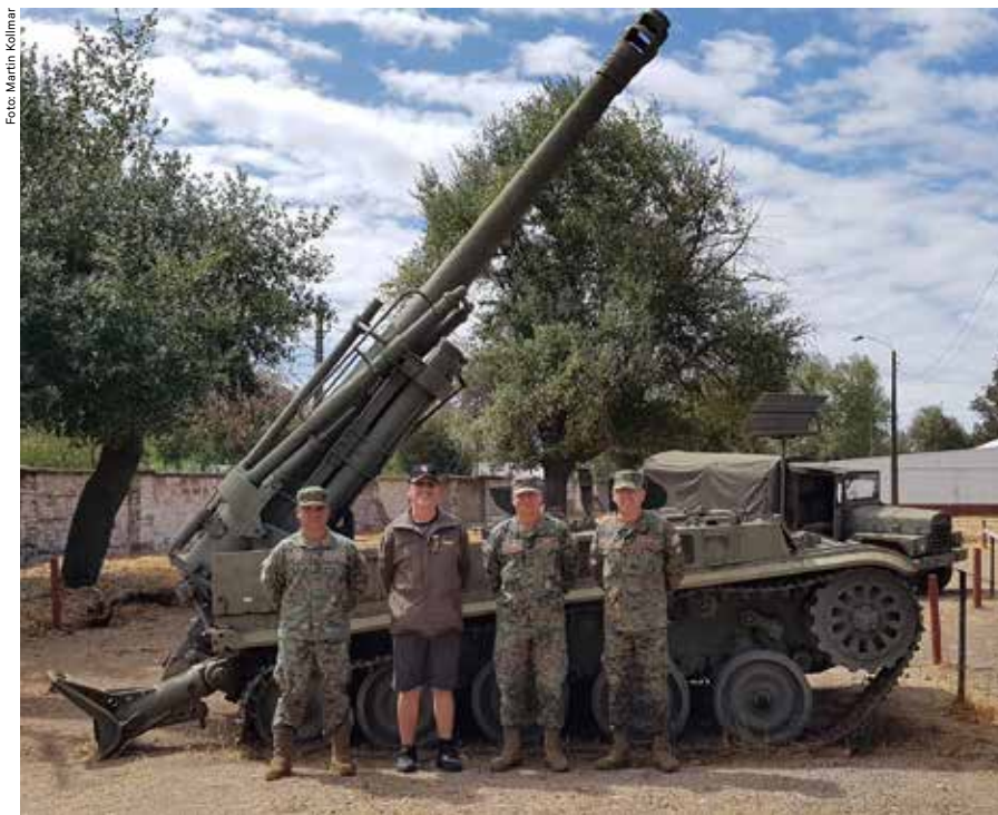
Diese historische 155 mm Feldhaubitze auf Selbstfahrlafette hat das Fahrgestell des französischen leichten Panzers AMX-13 und wurde bei der chilenischen Artillerie durch die Panzerhaubitze M109 als Hauptwaffensystem abgelöst
